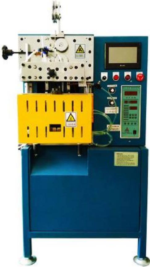
智能钢丝绳锥头熔断机，它的设计主要是针对封锁各种铅封钢丝绳、锁具钢丝绳、密封条钢丝绳、施等的生产加工行业批量的钢丝绳熔断后再磨尖和解决人工加工质量不稳定、工序繁多、以及日益严重的用工难情况，亦能节省人力、节省多个工序从而降低生产成本提高产能的全自动化设备，可以一人同时看管多台设备。
